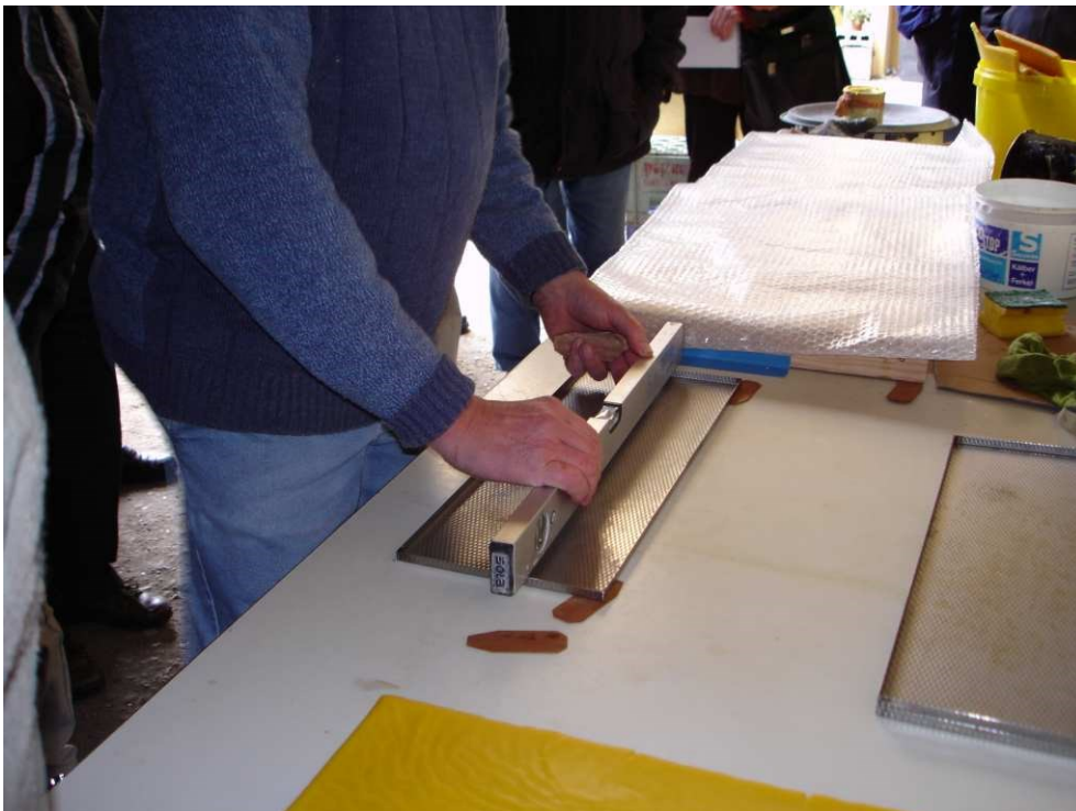
Gießform aus Edelstahl – in jedem Fall soll eine Wasserwaage zum Einsatz kommen
